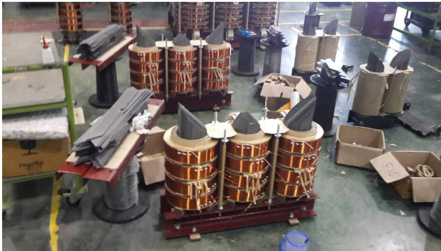
รูปที่ 2. ลักษณะแกนเหล็กและขดลวดของหม้อแปลงไฟฟ้า
